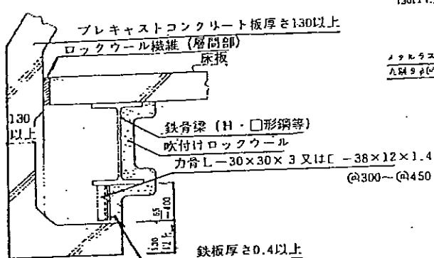
断面図2 鋼板(厚さ0.4以上)下地構成の場合
